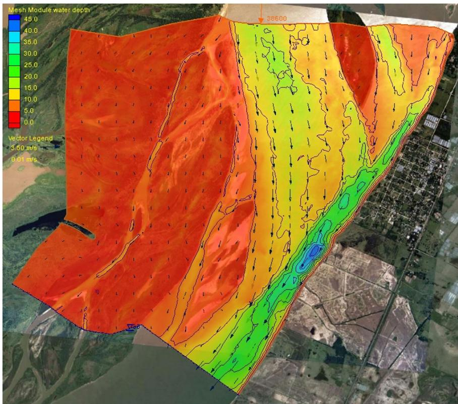
Modelo Hidrodinámico bidimensional Río Paraná en Lavalle Corrientes.
